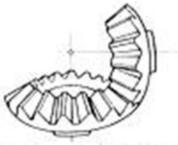
Le principal défaut des moteurs à courant continu, même de petite taille, est qu'ils fournissent une très grande vitesse de sortie. Il nous faut donc envisager un système de réduction mécanique entre la roue moteur et l'axe de rotation de l'aimant. Nous utiliserions des petits engrenages coniques en plastique. Leur coût varie entre 0.60€ et 4€ la pièce.
