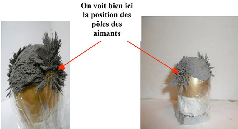
On notera que pour de meilleurs résultats les aimants sont placés de manière à ce que le champ magnétique soit perpendiculaire au flux d'électrons.
