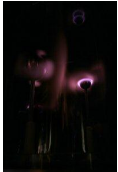
Figure 5 : Visualisation de la magnétopause avec la Planeterrella. ( http://planeterrella.obs.ujf-grenoble.fr/ )
